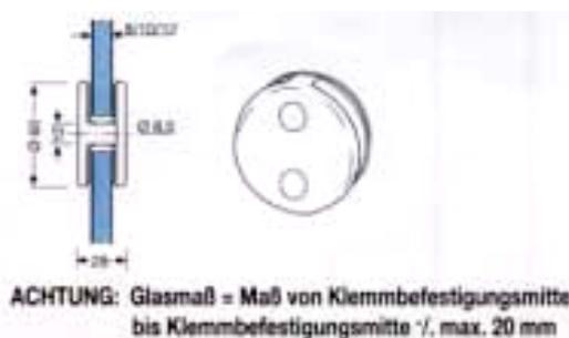
**5.9240.1** Klemmbefestigung für Geländer-Konstruktionen, Plattendicke **10 mm**, mit Gummi-Einlagen, zwei V2A Sicherungsschrauben M6 und Abdeckhauben, sowie mit Sicherungsstift. Rechts und links verwendbar. Standardausführung.
