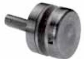
**5.9585.2** Klemmbefestigung für Geländer-Konstruktionen, für Plattendicke von **6-16 mm**, mit 2 Kunststoff-Unterlegscheiben, 1 Kunststoff-Schlauchstück, sowie mit 50mm Stockschraube für Holzmontage. Mit Grundkörper **Art.-Nr: 5.9580.2** **nur Aluminium roh (00)**
