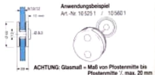
**5.9550.1** Anschraubteil zu Klemmbefestigungen (**Art.-Nr: 5.9500.1-5.9527.1**) passend, für **ebene** Montageflächen, horizontal, vertikal und in jedem Neigungswinkel stufenlos von **0-360 Grad** einsetzbar.
