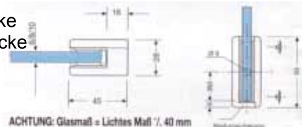
**5.9060.1** Eck-Klemmbefestigung, **links** mit Boden zur Absturzsicherung, für Geländerkonstruktionen, Plattendicke **6 mm**, mit Gummi-Einlagen, zwei V2A Sicherungsschrauben M6 und Abdeckhauben. Standardausführung.
